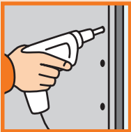
Mocowanie przykręcanie wkrętami do metalowej konstrukcji dolnej
