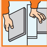
Łamanie nacięcie i złamanie płyty
