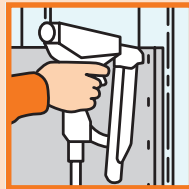
Mocowanie Klamrami do drewnianej konstrukcji dolnej
