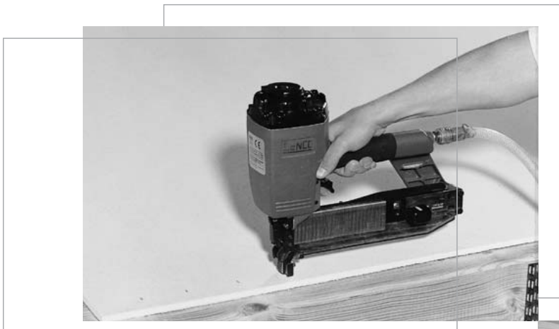
Ilustracja 16: Pistolet pneumatyczny do ręcznego przytwierdzenia płyt kłami
