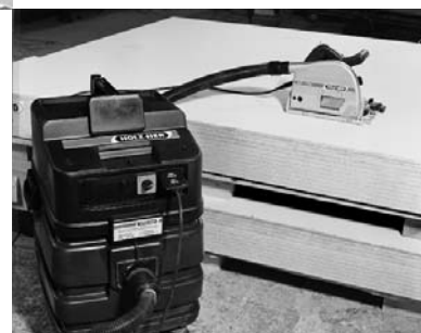
Ilustracja 10: Ręczna pilarka tarczowa z odkurzaczem do odsysania pyłu
