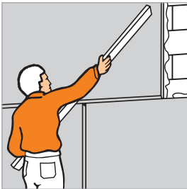
Rysunek 19: Płytę docisnąć lekko do ściany, a następnie ustawić w pionie stukając poziomnicą
