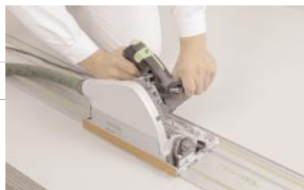
Ręczna pilarka tarczowa z tarczą z węglnikami spiekanyymi
