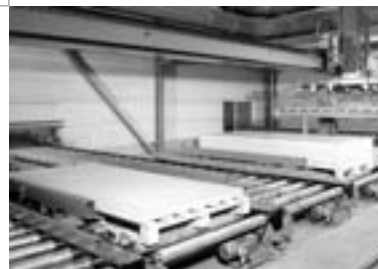
Ilustr. 1.4: Układanie płyt na paletach
