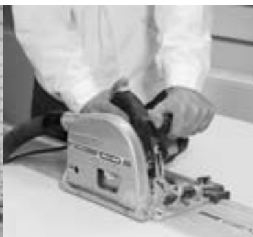
Ilustr. 3.2: Ręczna pilarka tarczowa na szynie prowadzącej
