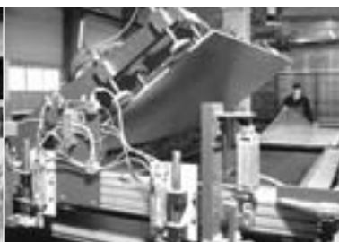
Ilustr. 1.3: W pełni zautomatyzowane wyjmowanie płyt z form
