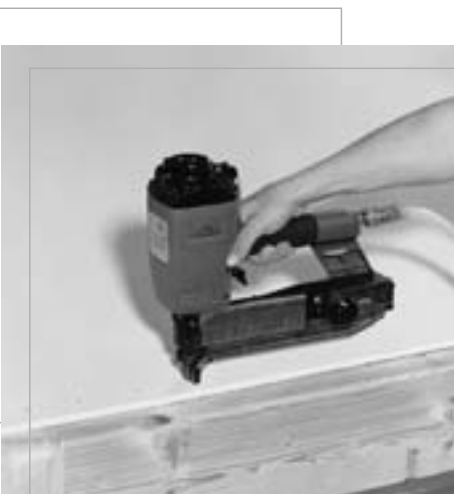
Ilustr. 3.9: Pistolet pneumatyczny do ręcznego przytwierdzania płyt klamrami
