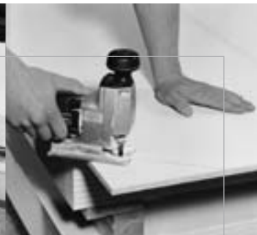
Ilustr. 3.4: Zastosowanie wyrzynarki do wykonania zaokrągleń i cięcia na wymiar.
