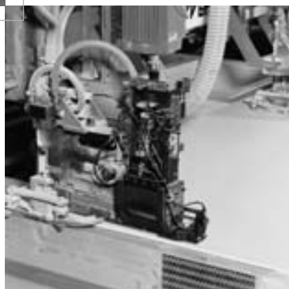
Ilustr. 3.10: Pomost klamrowy do maszynowego przytwierdzania płyt klamrami
