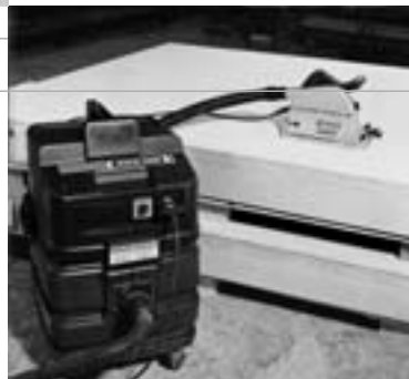
Ilustr. 3.3: Ręczna pilarka tarczowa z odkurzaczem.
