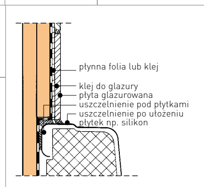
Zdjęcie 10: połączenie ściany FERMACELL o poszyciu jednowarstwowym z dodatkową płytą poszycia nad wanną
